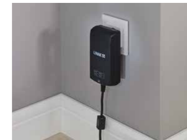
▲ Elektronisches Schaltnetzteil (Switch-Mode), direkt hinter Netzstecker integriert
