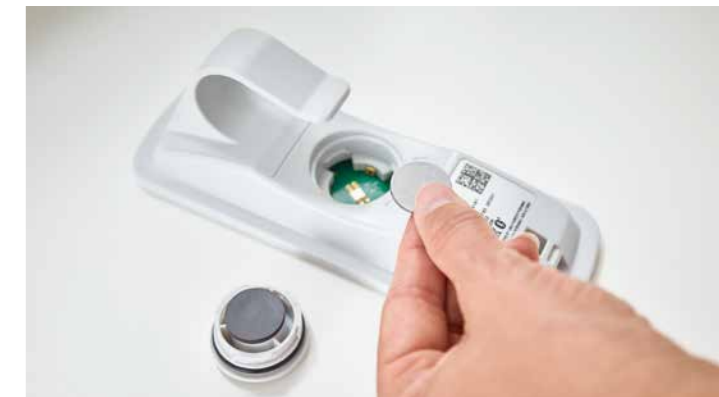
▲ Die handelsübliche Batterie lässt sich in wenigen Sekunden auswechseln.
