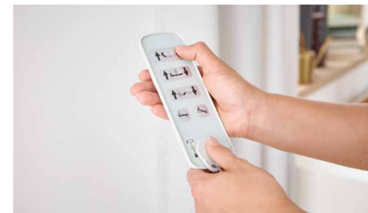
▲ Die Verstellfunktionen des Bettes können mithilfe eines Magneten einzeln gesperrt und entsperrt werden.
